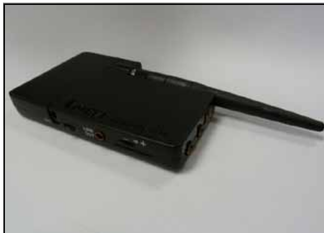
Figura 2: La Estación de Base del WV
