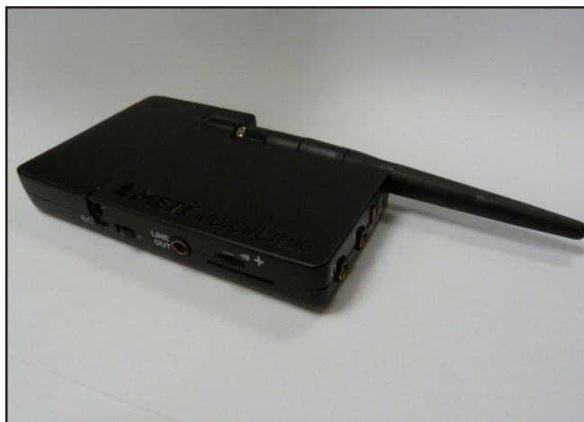
Рисунок 2. Базовая станция средства беспроводной передачи голоса
