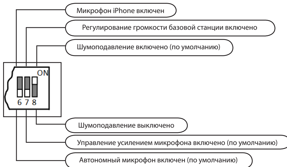
Рисунок 11. Расширенные настройки DIP-переключателя
