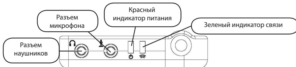
**Рисунок 3. Средство беспроводной передачи голоса, вид спереди**
