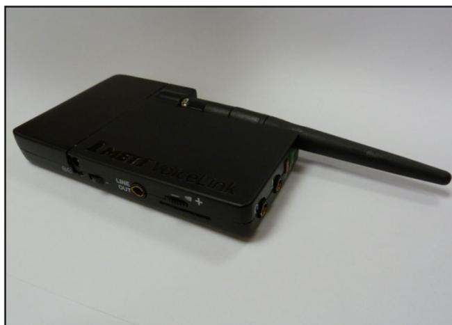
*Рисунок 2. Базовая станция средства беспроводной передачи голоса*
