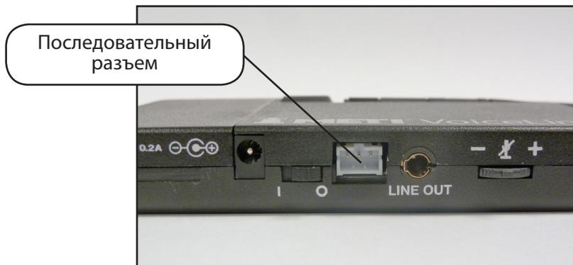
Рисунок 6. Последовательный разъем на базовой станции
