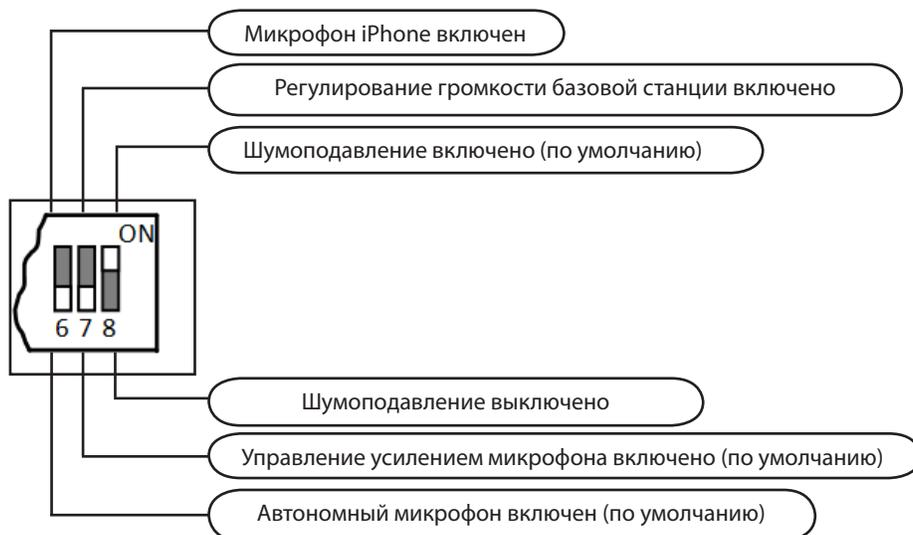
**Рисунок 12. Расширенные настройки DIP-переключателя**
