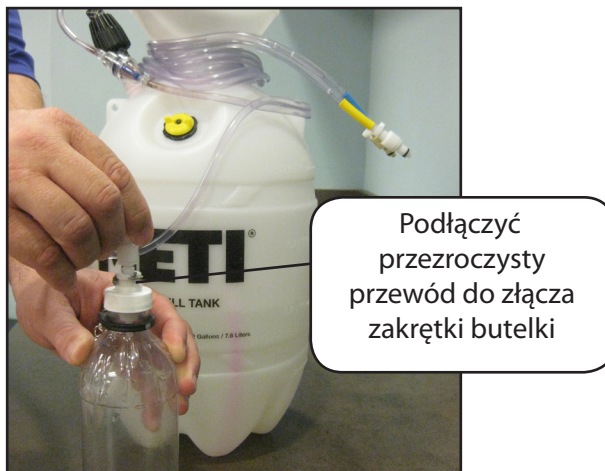
Podłączenie przewodu łączącego zbiornika wypełniania urazów do butelki przelewowej
