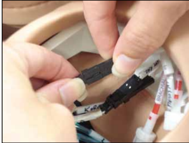
Desconexión de los Conectores Eléctricos
